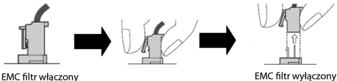
Uwaga: Włączanie lub wyłączanie filtra należy wykonywać przy niezasilanym urządzeniu.
