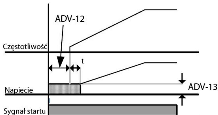
UWAGA: Napięcie DC podawane do silnika może spowodować jego przegrzanie lub uszkodzenia
