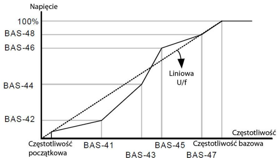
**UWAGA: W przypadku kiedy posiadamy standardowy silnik a charakterystykę U/f użytkownika zmienimy znacząco, może to spowodować zbyt niski moment obrotowy lub może nastąpić przegrzewanie silnika.**
