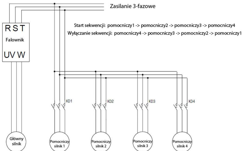
**2: Main** – Wybór tego trybu pozwala na pracę w zmieniającej się sekwencji wraz z silnikiem głównym pracującym pod przemiennikiem.
