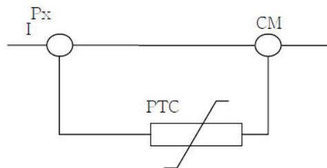
**PRT-36 (Thermal-T Lev)** – Ustawienie poziomu zadziałania czujnika termicznego silnika. W przypadku użycia wejścia napięciowego V1 maksymalne napięcie wejścia wynosi 10V, dla wejścia prądowego I1 , maksymalne napięcie wejścia wynosi 5V.
