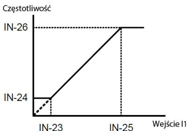
**IN-31 (I1 Inverting)** – parametr pozwalający na szybkie odwrócenie charakterystyki, powyżej (gdy ustawimy parametr na „Yes”)
