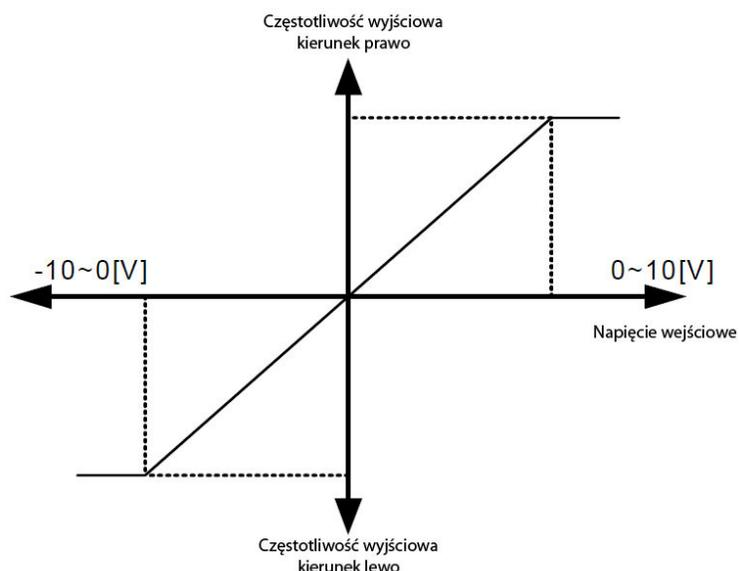
**IN-12 (V1(-) volt x1')** do **IN-15 (V1(-) Perc y2')** – w tych parametrach nastawiamy nachylenie charakterystyki sterowania sygnałem napięciowym V1 dla części ujemnej charakterystyki.
