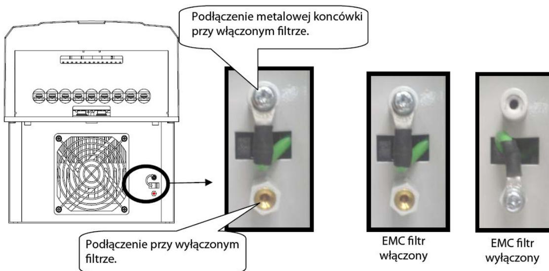
Filtr EMC redukuje zakłócenia elektromagnetyczne na wejściach układów przy symetrycznej metodzie uziemienia. Sprawdź czy używasz filtra EMC w układzie uziemienia symetrycznego jak np. układ gwiazdowy.
