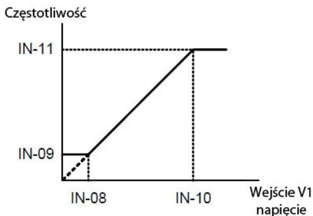
**IN-16 (V1 Inverting)** – parametr pozwalający na szybkie odwrócenie charakterystyki, powyżej (gdy ustawimy parametr na „Yes”
