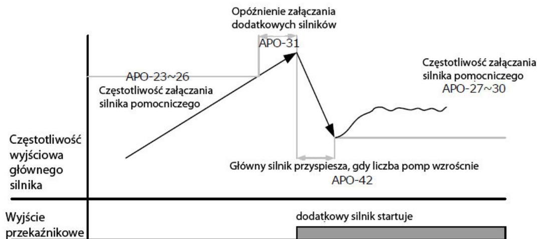
zatrzymanie sekwencji dodatkowych pomp gdy obciążenie wzrośnie
