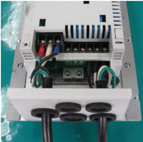
Założenie pokrywy i panela przeprowadzać w sposób odwrotny do demontażu.
