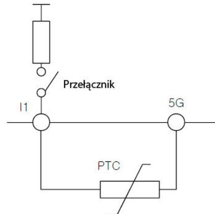
IN-65 ~ 75 (Px Define); IN-82 (DI NC/NO Sel) – W przypadku użycia czujnika bimetalowego jako zabezpieczenie termiczne silnika, możemy użyć wejścia cyfrowego wielofunkcyjnego Px. Podłącz czujnik bimetalowy PTC pomiędzy wejście i zacisk wspólny i należy ustawić wejście jako 39 „Thermal In”. Należy również ustawić typ wejścia jako normalnie zamknięty (IN-87).
