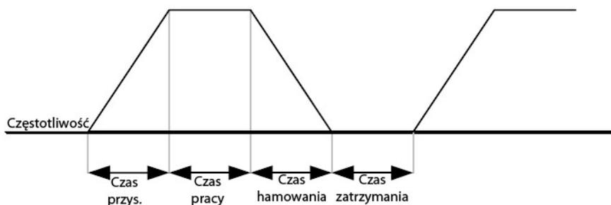
$$\%ED = \frac{T_{dec}}{T_{dec} + T_{steady1} + T_{acc} + T_{steady2}} \times 100[\%]$$
